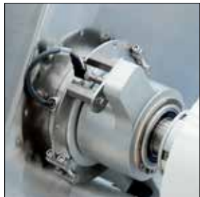
SISTEMA FRENATURA FILM / FREIN DE FILM
