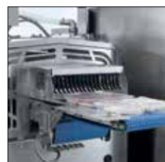
NASTRO USCITA MOTORIZZATO / TAPIS DE SORTIE MOTORISÉ
