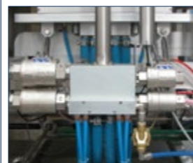
DOUBLE VALVE VACUUM & GAS SYSTEM / SYSTÈME DE GAZ SOUS VIDE AVEC DOUBLE VALVE
