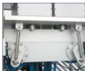
SERVO DRIVEN DOWN LIFTING SYSTEM / MOUVEMENT DE BAISSÉ ET LEVAGE DE LA CHAMBRE PAR SERVO MOTEUR
